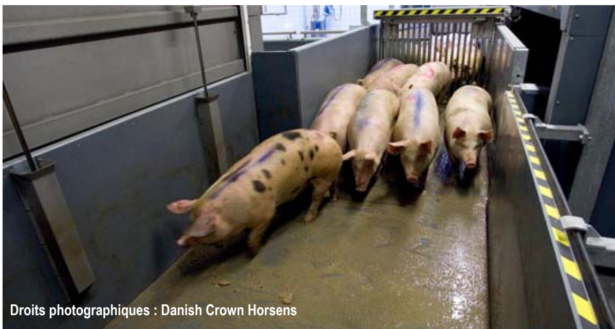
Figure 1 : Porcs en petits groupes conduits par des portes de poussée qui se déplacent lentement
